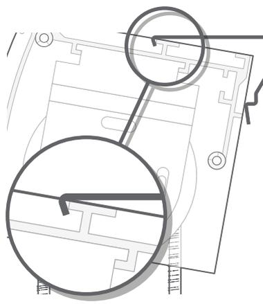
レールを斜めに持ち上げ上辺のT字のツメ(凸部)をブラケットの前側のツメに引っ掛けます。
