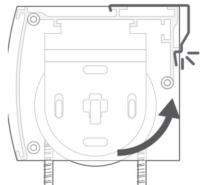
ヘッドレールの後ろ側を水平になるように持ち上げ、ブラケットの後ろ側の爪にカチッとハマるまで押し上げます。
