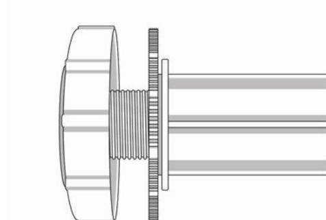
突っ張り部分を固定する際は、収納したねじの溝部分がすべて出ていることを確認してください。
