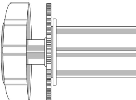
突っ張り部分はねじの溝部分をすべて収納した状態(ばねが効く状態)で窓内に入れ、突っ張ります。
