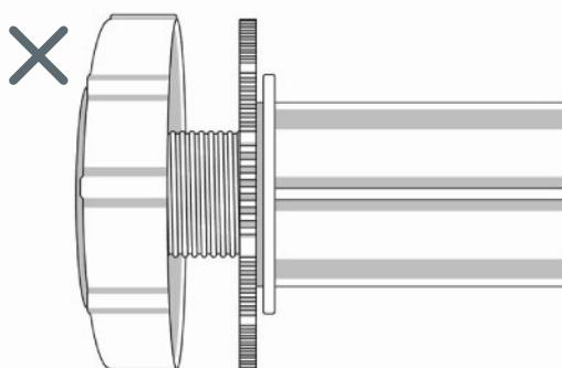
突っ張り部分のねじの溝部分がすべて見えている状態。
