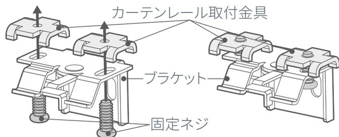
カーテンレール取付金具をブラケットの上に置き、固定ネジをドライバーで仮止めする。
