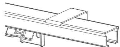
仮止めしたままカーテンレール取付金具をカーテンレールに挿入する。
